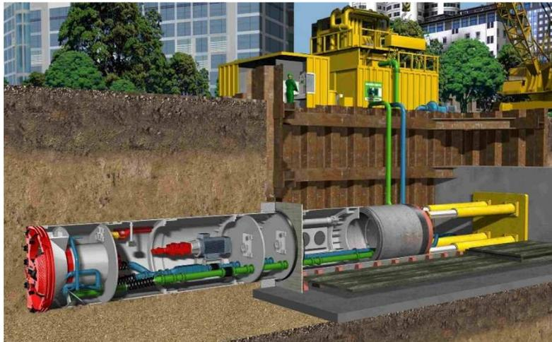
Si è optato per predisporre la camera di spinta a valle dell'attraversamento, poiché la zona è più facilmente raggiungibile dalla strada provinciale SP 31 bis, sia per il trasporto delle attrezzature (macchina per jet-grouting, macchina per l'infissione delle palancole e testa fresante microtunnelling con relative cabine di comando e vasca miscelazione fanghi bentonici), sia per la consegna delle tubazioni in c.a..
