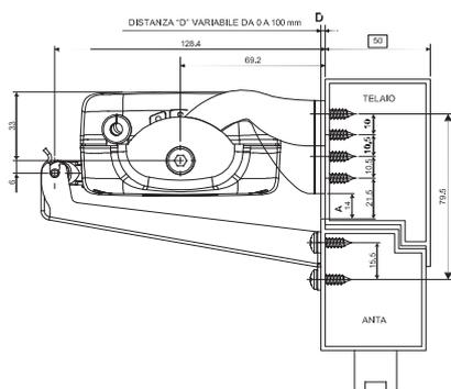
TUTTI I SERRAMENTI IDENTIFICATI CON IL CODICE "W10", POSIZIONATI IN ALTO SUI PROSPETTI E NON RAGGIUNGIBILI PER L'APERTURA MANUALE, DOVRANNO ESSERE FORNITI IN OPERA DOTATI DI AUTOMAZIONE A CATENA PER L'APERTURA DEI SERRAMENTI A VASISTAS.
