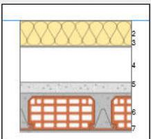
*Stratigrafia copertura S2 post-operam (copertura blocchi spogliatoi e ingresso con solaio sano)*
