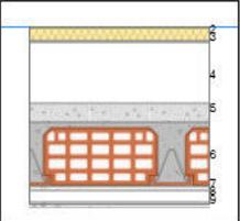
*Stratigrafia copertura S3 ante-operam (copertura blocchi spogliatoi e ingresso con solaio rivestito antisfondellamento)*
